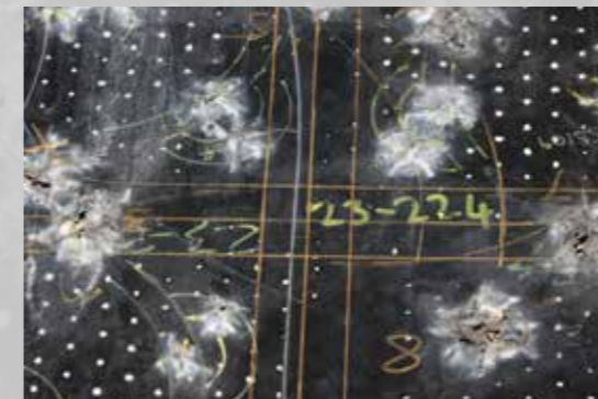
اختبار حل التدريع لمستوى التهديد الرابع حسب معيار STANAG
